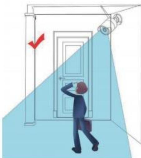
人や動物が検知エリア内カメラと並行に移動する時カメラがすぐ検知される
