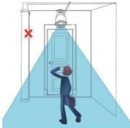
人や動物が検知エリア内カメラレンズに向き直線的に移動する時カメラがすぐ検知されない場合がある
